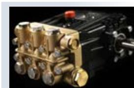
Плунжерный низкооборотистый насос высокого давления UDOR снабжен штампованным коленчатым валом, керамическими плунжерами, клапанами из нержавеющей стали, не нуждается в техническом обслуживании (только замена масла)
