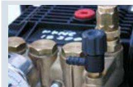
Устройство всасывания автоматически дозирует моющие средства в концентрации до 10%
