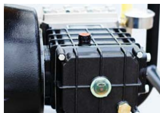
Маслонаполненный картер с системой смазки коленвала
